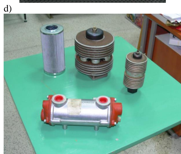
Fot. 7. Widok wykonanych pomocy dydaktycznych: a) modele silników, b) model Orbitrol'a, c) tablica złączy hydraulicznych, d) filtry i chłodnice
