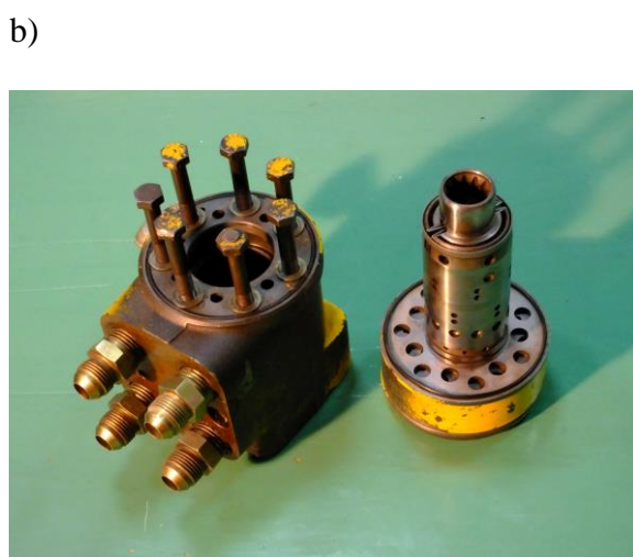
Fot. 7. Widok wykonanych pomocy dydaktycznych: a) modele silników, b) model Orbitrol'a, c) tablica złączy hydraulicznych, d) filtry i chłodnice
