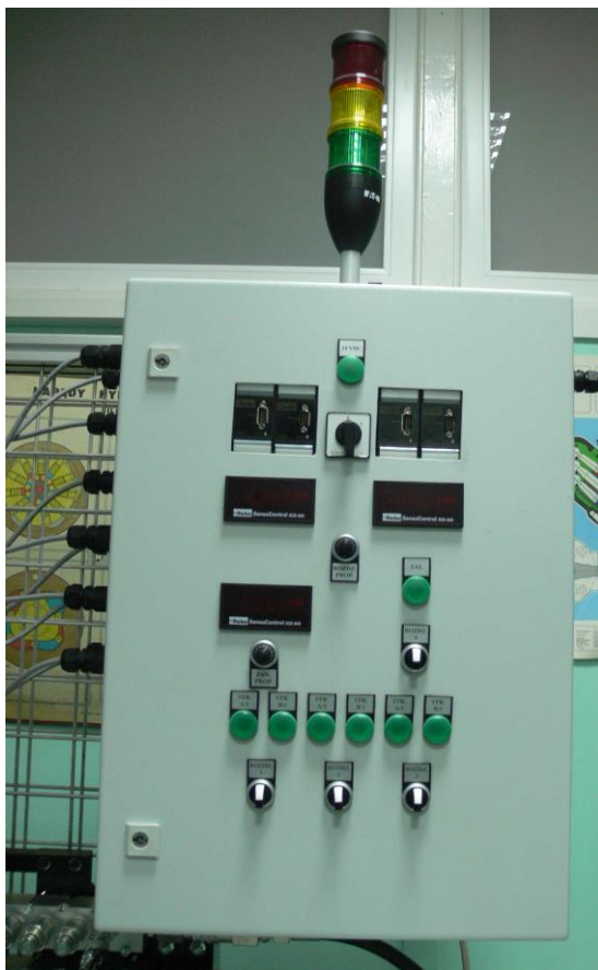
Fot. 2a. Widok szafy sterowniczej stanowiska nr 1 i 2 z kartami pomiarowo sterującymi
