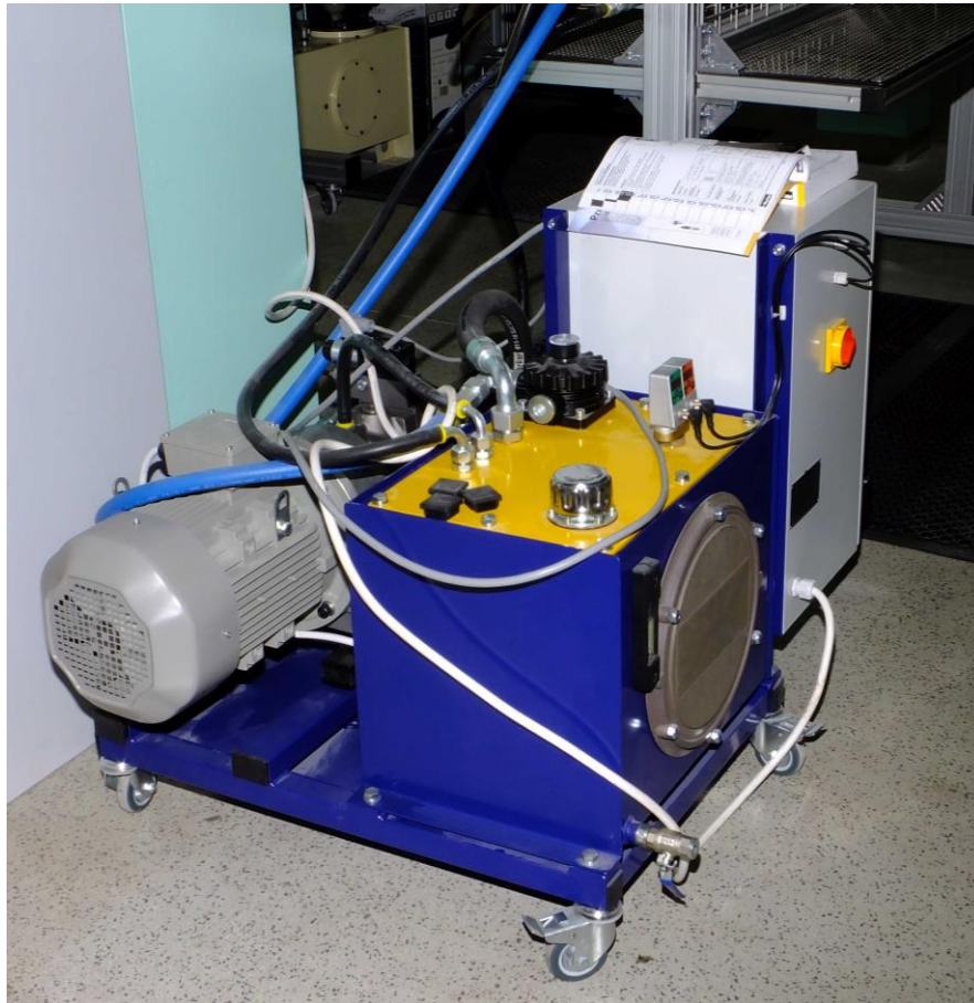
Fot. 3a. Widok zasilacza hydraulicznego stanowiska 1 i 2
