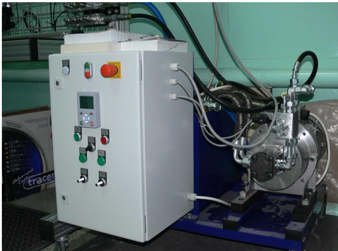
Fot. 3b. Widok zasilacza hydraulicznego stanowiska 1 i 2
