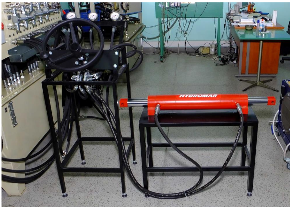
Fot. 6. Widok stanowiska do badania pełno-hydraulicznego układu wspomagania skrzętu kół jezdnych pojazdów wolnobieżnych
