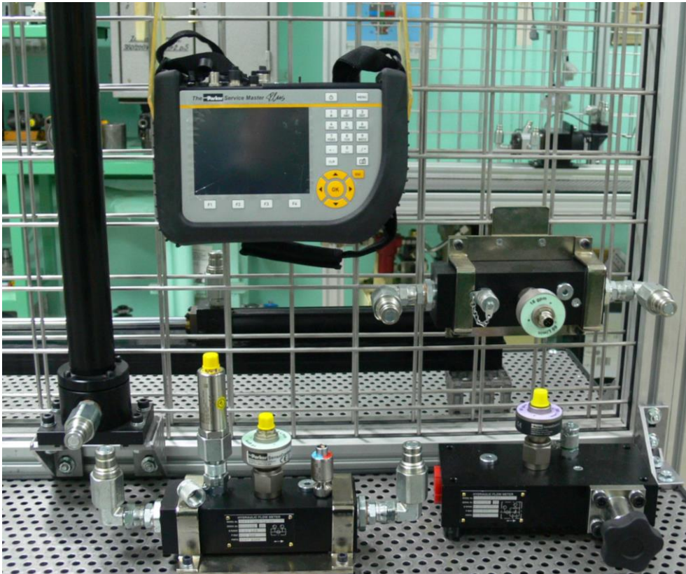
Fot. 5. Widok zestawu przetworników pomiarowych wraz z przyrządem rejestrującym wybrane wielkości fizyczne w zestawianych układach hydrostatycznych
