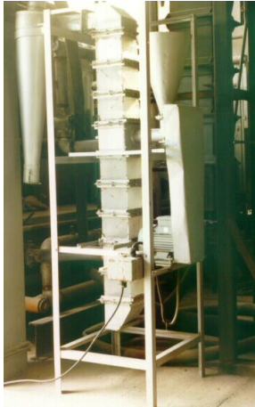
Rys. 1. Stanowisko doświadczalne a) widok, b) schemat: 1-cyklon, 2-klasyfikator kaskadowy, 3-zasobnik materiału, 4-rotametr, 5-dmuchała, 6-filtr.
