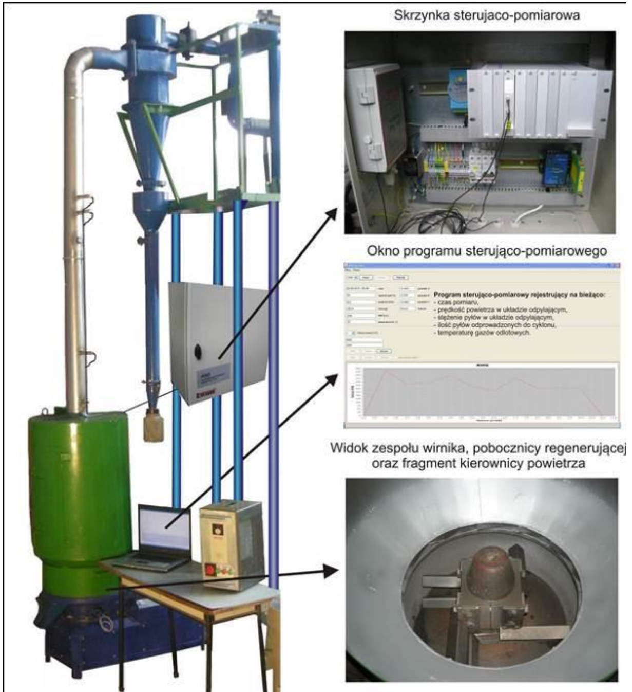
Rys. 1. Ogólny widok urządzenia ścierającego (aparatu testowego) do badań regenerowalności różnych rodzajów masy zużyte.
