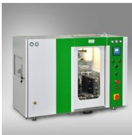
Rys. 2. Widok strzelarki laboratoryjnej stosowanej podczas ćwiczeń
